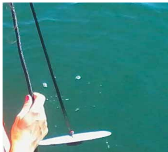
Определение прозрачности воды с помощью диска Секки
