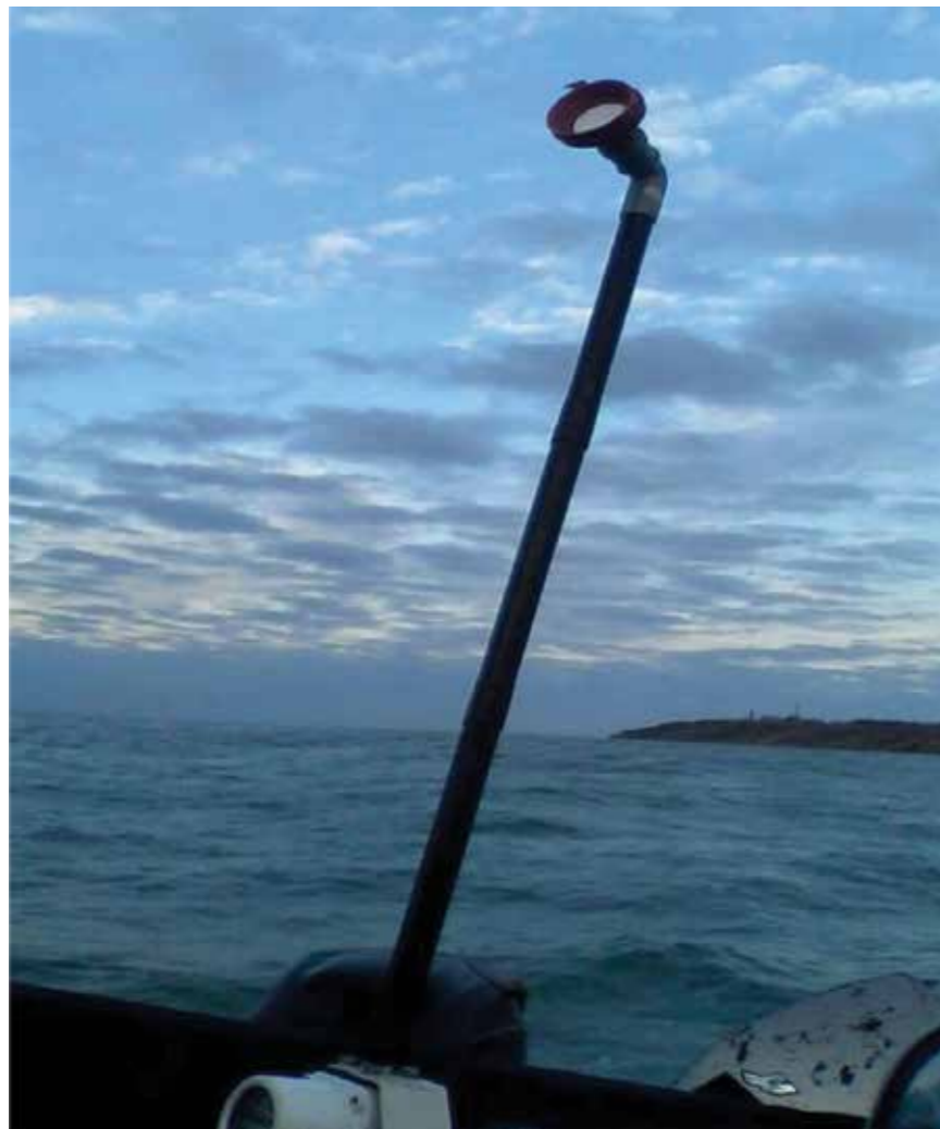
Отбор проб атмосферного воздуха с помощью устройства ПУ-4Э на акватории
